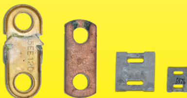
经300小时20%的盐雾测试后红铜、黄铜和电镀的保险扣
